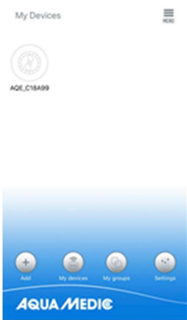
Fig. 29 : Sous le point de menu « My groups », il est possible de combiner plusieurs pompes en un seul groupe et de les programmer ensemble.
