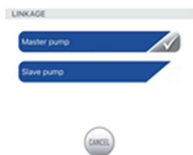
Rys. 20: W tym menu określa się, czy pompa będzie nadrzędna (Master) czy (Slave). Tylko jedna pompa może być ustawiona jako MASTER. Ustawienie więcej niż jednej pompy w trybie MASTER będzie skutkowało chaotyczną pracą.
