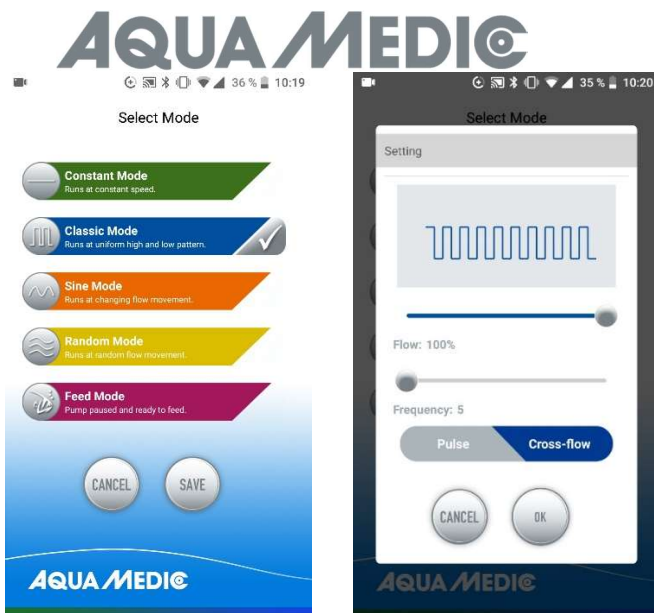
Abb. 26: ... tippt auf das Wellen-Symbol vor „Classic Mode“ und wählt „Crossflow“ an (ist danach blau hinterlegt). Unter „Flow“ wird die Pumpenleistung variiert, mit „Frequency“ die Ein- und Ausschaltzeit (Minimum ca. 30 Sekunden, Maximum ca. 90 Minuten). Mit „OK“ und „Save“ wird abgespeichert. Es kann bis zu drei Zyklen dauern, bis die Pumpen ihren Wechselrhythmus „gefunden“ haben. Deswegen sollte man zunächst mit einem Zyklus in niedrigster Stufe starten und diesen erhöhen, wenn die Pumpen gleichmäßig wechseln.
